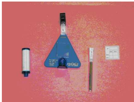
Illustration n° 4 : Badge pour le benzène : la cartouche (à droite) sera insérée dans un corps diffusif (à gauche) et fixée sur un badge (en bleu) qui sera exposé à l'extérieur
