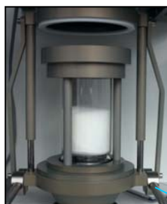
Nacelle contenant la mousse en polyuréthane
