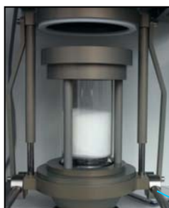
Nacelle contenant la mousse en polyuréthane
