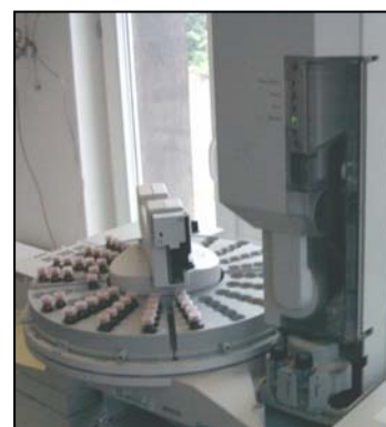
Passeur d'échantillons de l'appareil ICP-MS servant aux analyses
