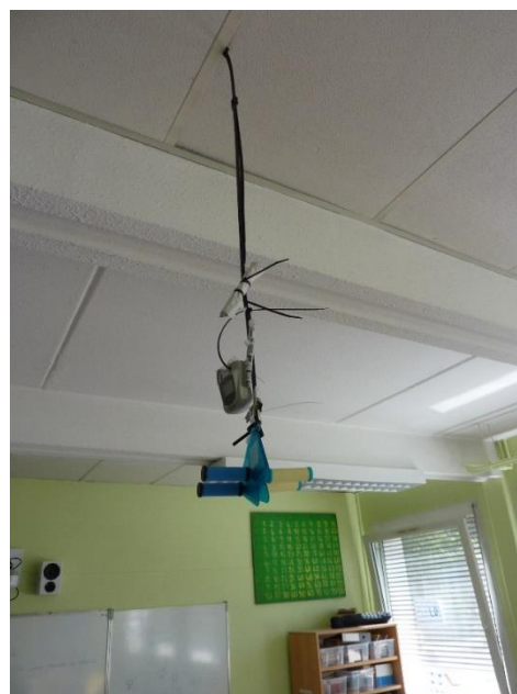
Tubes passifs installés dans une salle de classe (source : ATMO Grand Est)
