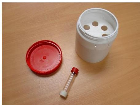
Tube passif NO<sub>2</sub> avec abri (Source : ATMO Grand Est)
