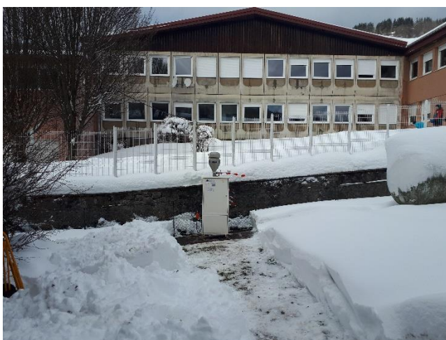
Préleveur d'Hydrocarbures aromatiques polycycliques installé à proximité de l'école primaire de La Bresse (Source : ATMO Grand Est)
