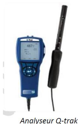
Analyseur Q-Trak pour mesurer les taux de dioxyde de carbone (Source : Eco Environmental)
