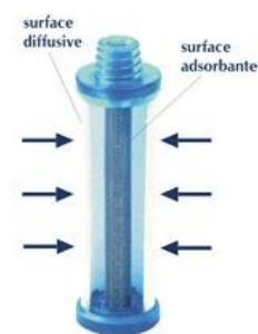
radiello en section. Les surfaces diffusive et adsorbante sont cylindriques et coaxiales: une grande surface diffusive fait face, à distance constante, à une petite cartouche concentrique.
