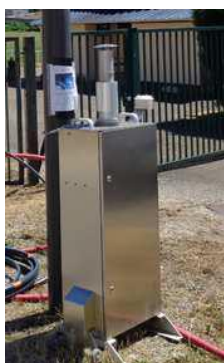
Préleveur actif de type Leckel pour prélever les particules (PM10) et (PM2,5)
