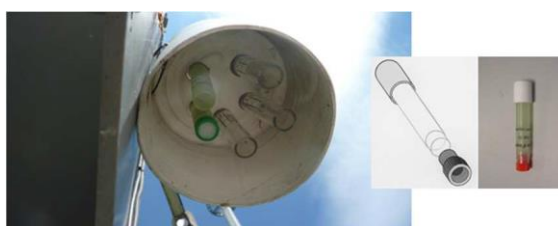
Tubes passifs pour prélever le dioxyde d'azote
