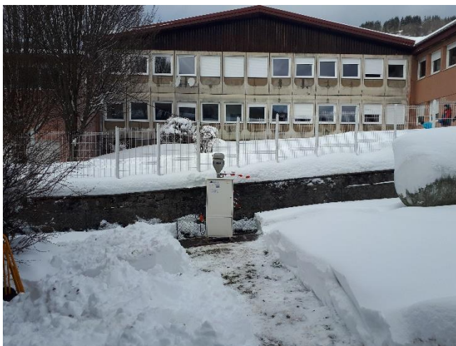
Préleveur d'Hydrocarbures aromatiques polycycliques installé à proximité de l'école primaire de La Bresse (Source : ATMO Grand Est)
