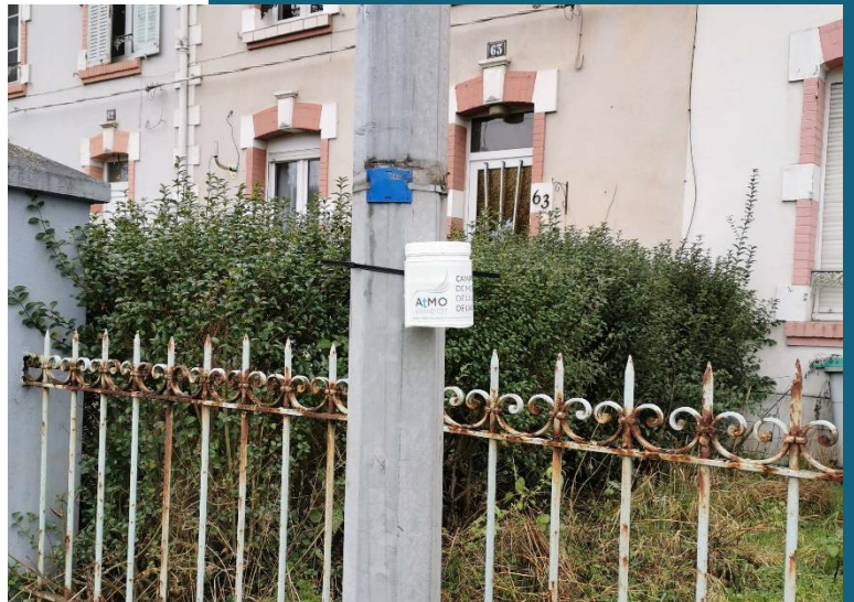
Abri pour tubes passifs installé sur un lampadaire à Longwy (Source : ATMO Grand Est)
