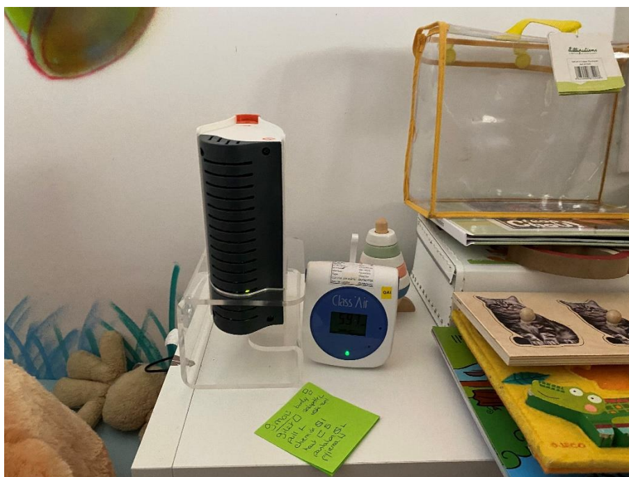
Figure 2 : Capteur de dioxyde de carbone dans une des chambre d'enfant (Source : ATMO Grnd Est)
