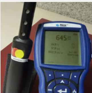
Figure 8 : Q-trak sonde 980
