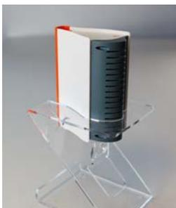
La station Fireflies®Q.E.I commercialisée par Haeger Services est un boîtier multicateur de mesure en continu. Les mesures effectuées par cette balise ne correspondent pas à une méthode de mesure normalisée, plus précise et spécifique, mais permettent de visualiser la dynamique des concentrations intérieures au cours d'une journée ou d'une semaine.
