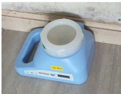
Des prélèvements d'air ont été réalisés par le biais d'un biocollecteur sur des géloses (milieu Sabouraud). Les géloses ont été incubées à 35 °C pendant 5 jours puis une identification et une semi-quantification ont été réalisées au microscope par le laboratoire d'Hygiène Hospitalière des Hôpitaux Universitaires de Strasbourg.
