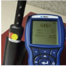
Les teneurs en dioxyde de carbone ont été mesurées avec un analyseur Q-Trak (sonde infrarouge non-dispersive 980) toutes les 10 minutes.
