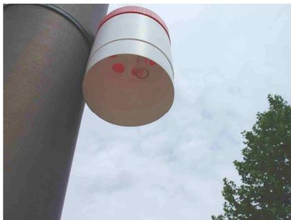
*Photo n° 1 : photographie d'un tube NO<sub>2</sub> sur le terrain*
