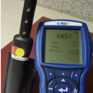
Figure 2 : Q-trak sonde 980
