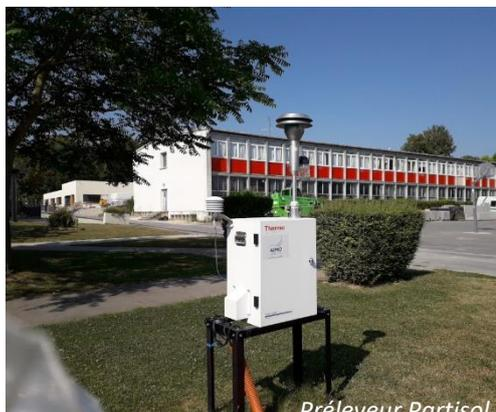
Le filtre et la mousse sont préalablement conditionnés par le laboratoire chargé des analyses afin d'éliminer toute souillure accidentelle extérieure. Les prélèvements hebdomadaires sont changés le lundi. Après prélèvement, les supports sont stockés à une température inférieure à -18°C jusqu'à l'analyse.
