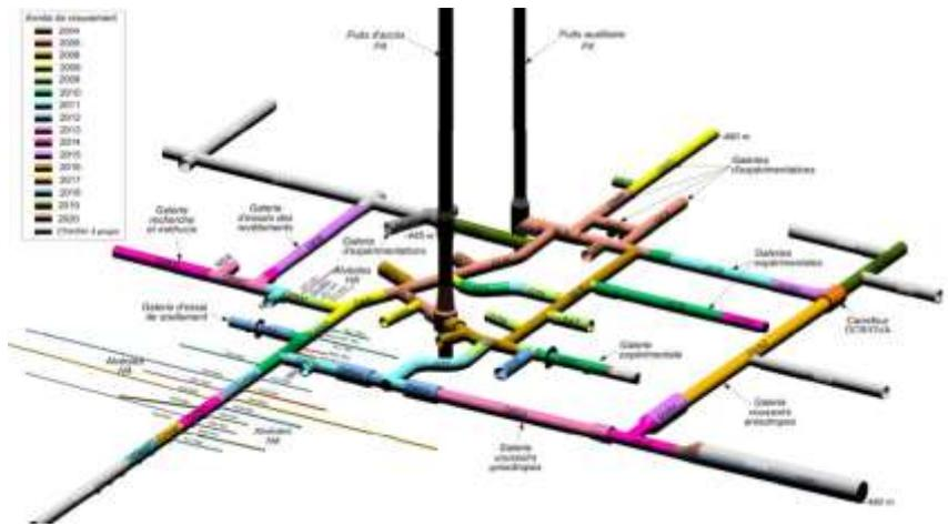
Figure 1 : Installations souterraines du laboratoire (source ANDRA)
