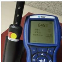
Les teneurs en dioxyde de carbone ont été mesurées avec un analyseur Q-Trak (sonde infrarouge non-dispersive 980) ou par des Class'Air, toutes les 10 minutes.
