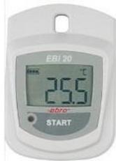
La température et l'humidité relative ont été suivies en continu par des sondes Ebro EBI 20-T-Ex déployées dans les sites intérieurs et extérieurs.
