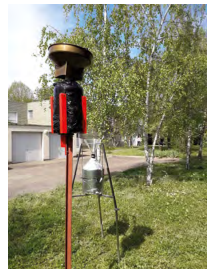
Jauges de mesure des retombées atmosphériques totales
