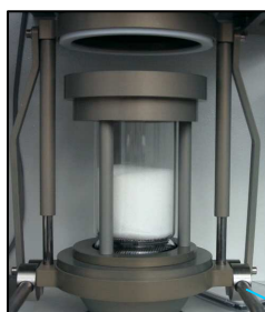
Nacelle contenant la mousse en polyuréthane
