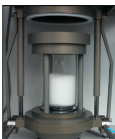
Nacelle contenant la mousse en polyuréthane
