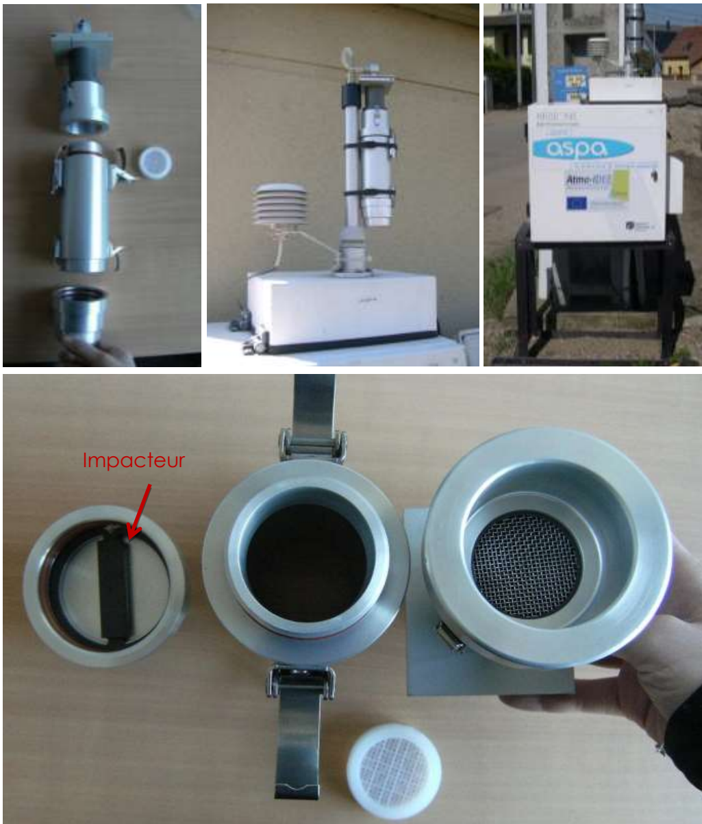
Illustration 06 : Préleveur Partisol Plus sur support (en haut à droite) – Raccord préleveur/ cartouche (en haut au milieu) – Cartouche Chemcomb ® (en haut à gauche) – Intérieur de la cartouche (en bas)
