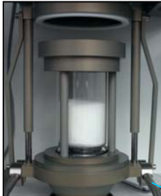
Nacelle contenant la mousse en polyuréthane
