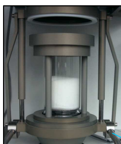
Nacelle contenant la mousse en polyuréthane
