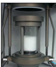
Nacelle contenant la mousse en polyuréthane
