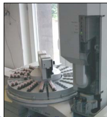
Passer d'échantillons de l'appareil ICP-MS servant aux analyses
