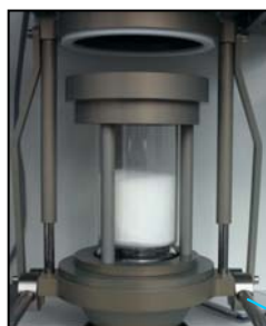
Nacelle contenant la mousse en polyuréthane
