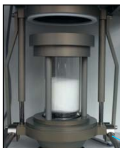
Nacelle contenant la mousse en polyuréthane
