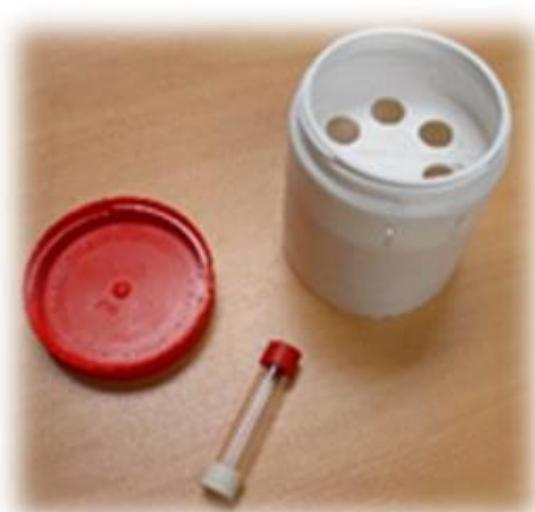
*Tube passif pour le prélèvement du  $\text{NO}_2$*
