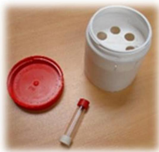
*Tube passif pour le prélèvement du  $\text{NO}_2$
