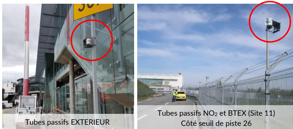
Figure 2 : Système de tubes passifs (support, boîtes et tubes)
