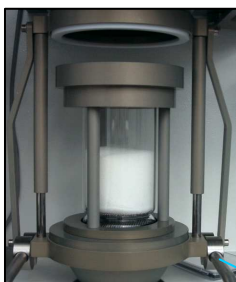
Nacelle contenant la mousse en polyuréthane
