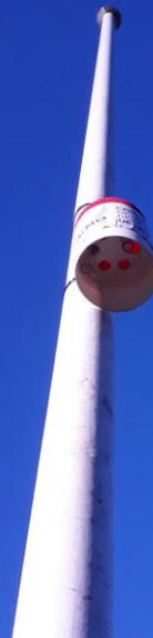
Tubes passifs pour le NO<sub>2</sub> sur des mâts installés par la ville de Metz ou sur des poteaux électriques
