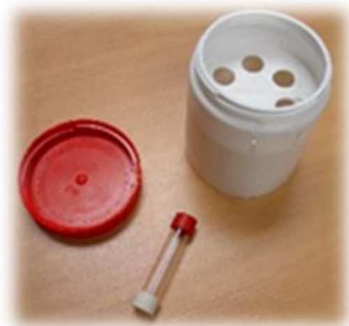
Tube passif pour mesurer le dioxyde d'azote (Source : ATMO Grand Est)
