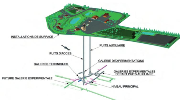
Figure 1 : Architecture du laboratoire souterrain à Bure (Source : ANDRA)
