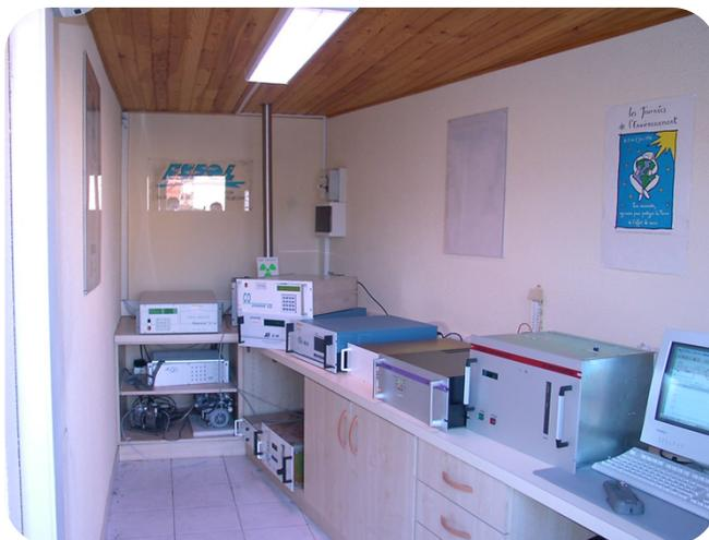
Analyseurs automatiques dans une station fixe (Source : ATMO)
