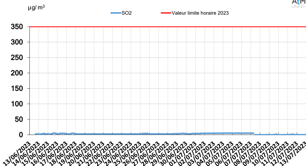
Figure 14 : Evolution des valeurs moyennes horaires en SO 2 à La Ferme du Cité (source ATMO Grand Est)
