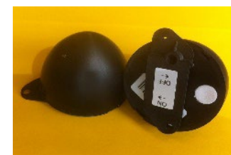
Dosimètre de mesure du radon
