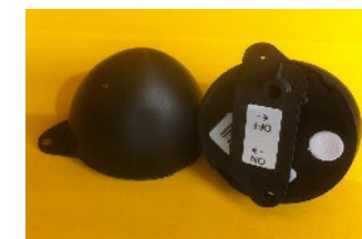
Dosimètre de mesure du radon
