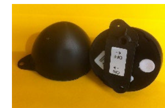
Dosimètre de mesure du radon
