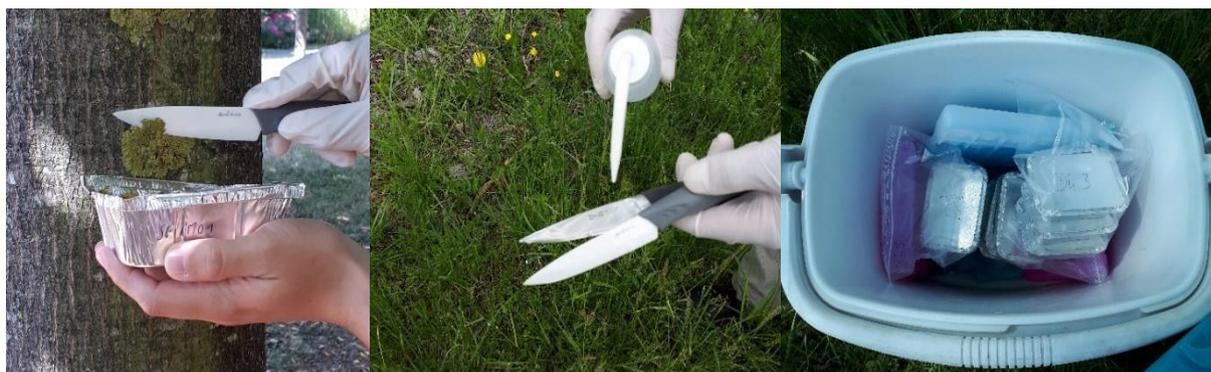
Figure 12 : Prélèvements des lichens, nettoyage des couteaux et conditionnement des échantillons.
