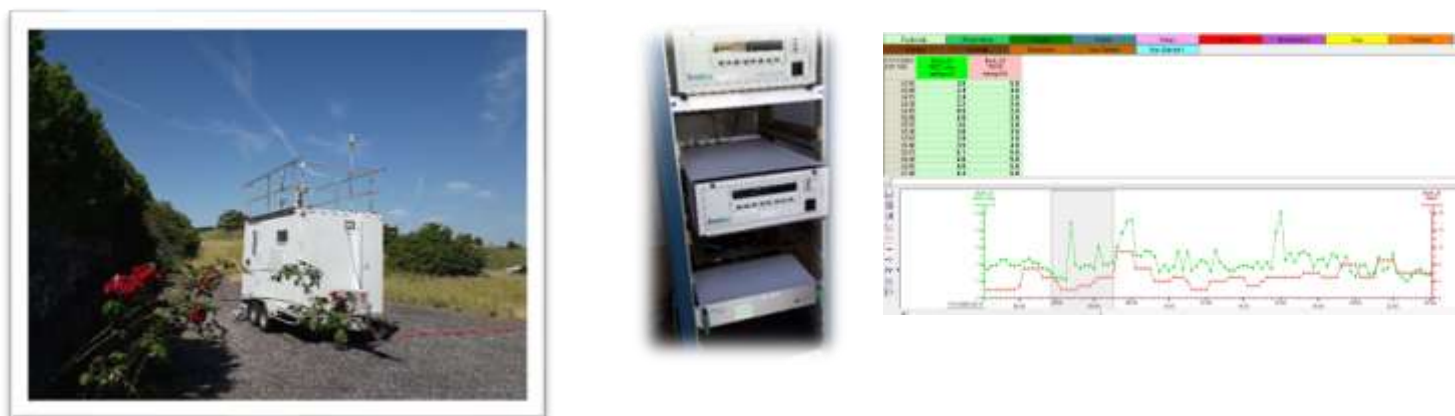
Figure 8 : Photographie du moyen mobile équipé d'analyseurs, positionné à la Ferme du Cité, et exemple de résultats issus des appareils de mesures en continu
