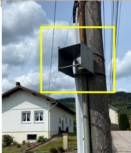
Tube passif préleveur BTEX
