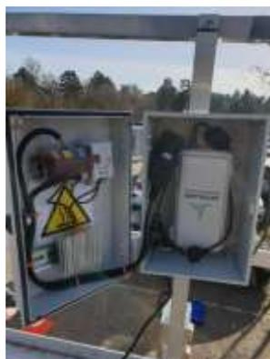
*Appareil de mesure du black carbon sur le site de mesures*
