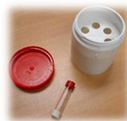
*Tube passif pour le prélèvement du NO<sub>2</sub>*
