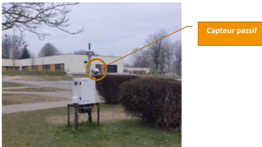
Figure 2 : Préleveur actif et capteur passif
