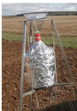
Figure 2 : Jauge pour le prélèvement des retombées atmosphériques totales
