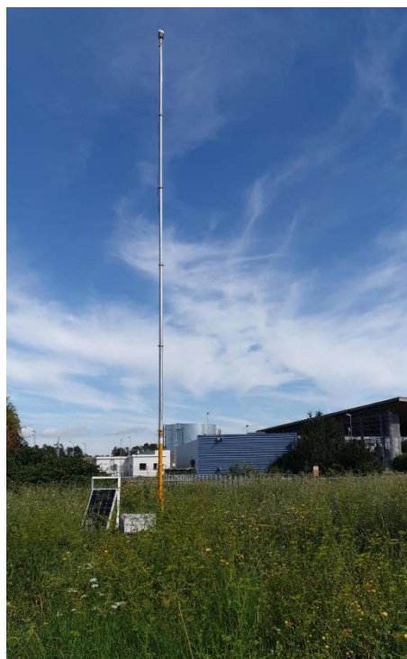
Figure 3 : Mât équipé d'une station météorologique installé sur le site d'AUREADE
