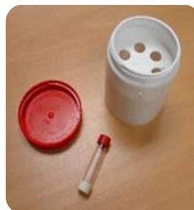
*Système capteurs pour mesure du NO<sub>2</sub>, PM<sub>10</sub> et PM<sub>2,5</sub> (à gauche). Tube passif pour le prélèvement du NO<sub>2</sub> (à droite).*
