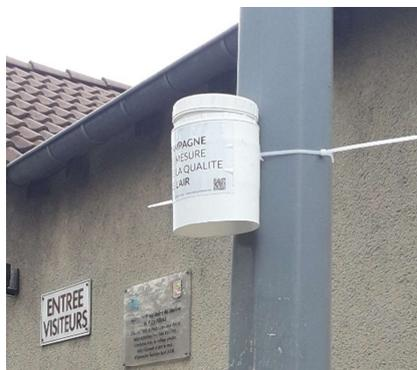
Figure 3 : Tube passif et son support (gauche) et boîtier de protection d'un tube accroché pour prélèvement (droite)
