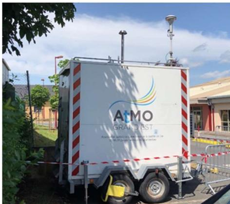
Figure 2 : Unité mobile dotée d'analyseurs automatiques
