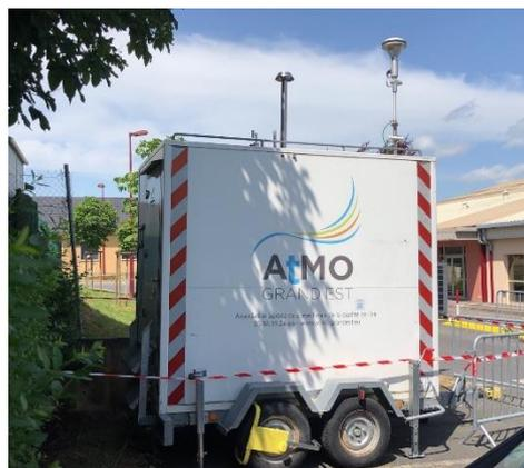
Figure 14 : Unité mobile (droite) et station fixe du réseau ATMO Grand Est (gauche) dotées d'analyseurs automatiques
