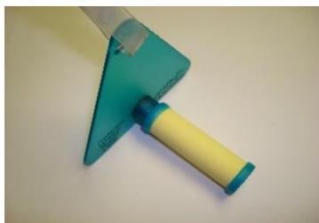
Figure 15 : Tube de prélèvement passif et son support
